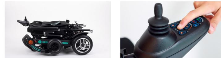
• 2. Presione el botón 11 (el botón de señal de giro a la derecha) como se muestra en la primera imagen, la silla de ruedas comienza a desplegar-se y suelte la mano para detenerse (si mantiene presionada esta tecla durante 5 segundos, se desplegará automáticamente después de soltar la mano) como se muestra en las siguientes imágenes.
