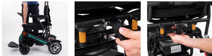
• 3. Al plegar: vaya a la parte posterior de la silla de ruedas, busque la hebilla de seguridad en forma de U, extráigala con la mano, retire completamente la hebilla de seguridad como se muestra en la segunda y tercera imagen.
