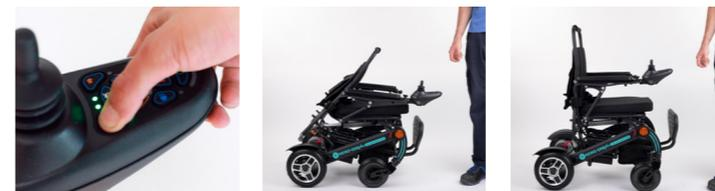
• 3. Al plegar, primero presione y mantenga presionado el botón 9 hasta que la luz indicadora esté encendida (como se muestra en la primera imagen) para ingresar al modo de plegado; luego, como se muestra en la primera imagen, presione el botón 10 (la tecla de luz de giro a la izquierda), la silla de ruedas comenzará a plegarse (si mantiene presionado este botón durante 5 segundos, suelte la mano, la silla de ruedas se puede plegar automáticamente), como se muestra en las siguientes imágenes.
