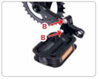
tener la extensión máxima alcanzable y en la posición superior la doblez máxima alcanzable de la rodilla. Ese ajuste se efectúa en relación con la altura del sillín. Para ajustar el reductor de biela regulable sin fases suelte los tornillos (B) y colóquelo en la posición deseada.
