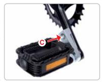
dad de la rodilla. En la posición inferior del pedal debe tener la extensión máxima alcanzable y en la posición superior la doblez máxima alcanzable de la rodilla. Ese ajuste se efectúa en relación con la altura del sillín. Para ajustar el reductor de la biela suelte los pedales con una llave fija del 15 y fije la abertura (C).
