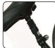
P5 - Tubo de sillín con amortiguador
