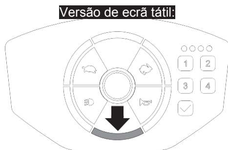
Figura 27 Normal: luz fixa Anormal: luz intermitente
