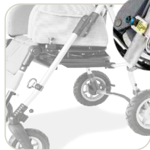
891 Anclajes para base de exterior 869 (4 anillos) para el transporte, en dirección del sentido de marcha, en vehículos en movimiento (coches privados, autobuses, etc.)
