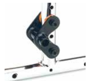
Eje atrasado Centro de gravedad -50mm Silla más estable
