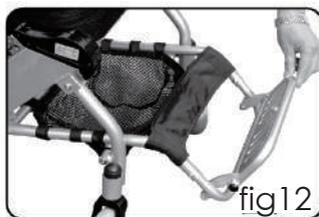
Con el fin de uso conveniente para usted, la silla de ruedas está equipado Con dos palancas de bloqueo del motor, cuando hacia abajo la palanca de bloqueo del motor a "manual", la silla de ruedas está en modo manual, que se puede empujar con las manos; Cuando la palanca de bloqueo del motor hacia arriba es "eléctrica", la silla de ruedas está en modo eléctrico, que no puede mover la silla por las manos (figura 11)
