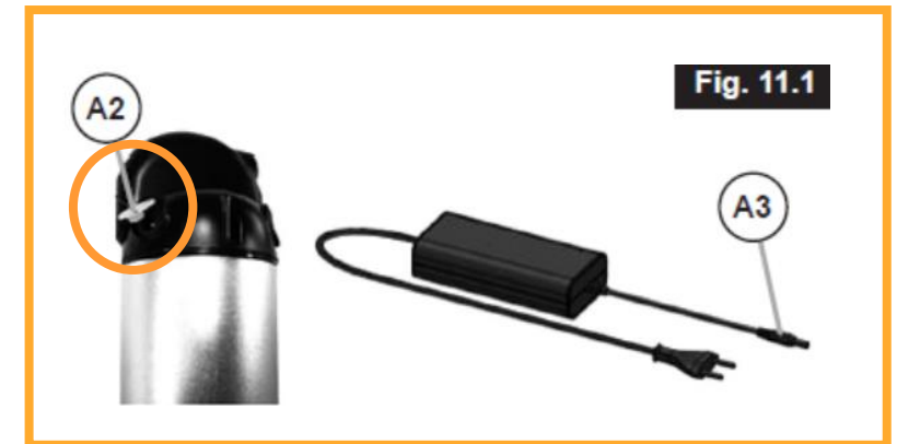
Punto de carga en la batería – levantar la tapa amarilla (A2)
