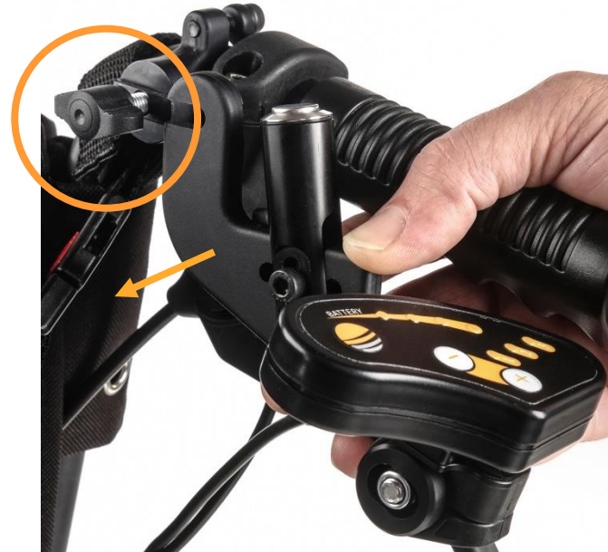
Fácil desmontaje, mediante pomo roscado
