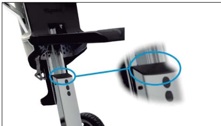
2. Figura 20 Cubierta de altura del asiento
