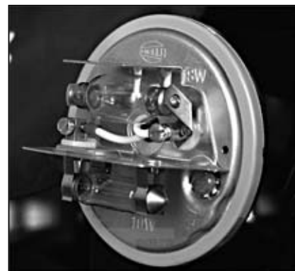
Fig. 23 Iluminação traseira sem cobertura de lâmpada
