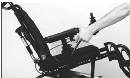
Fig.18 Basculamento mecânico do assento
