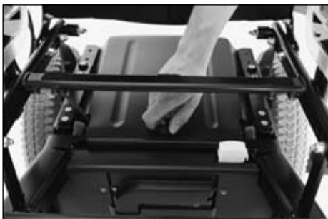
Fig. 16 Retirar la tapa de las baterías
