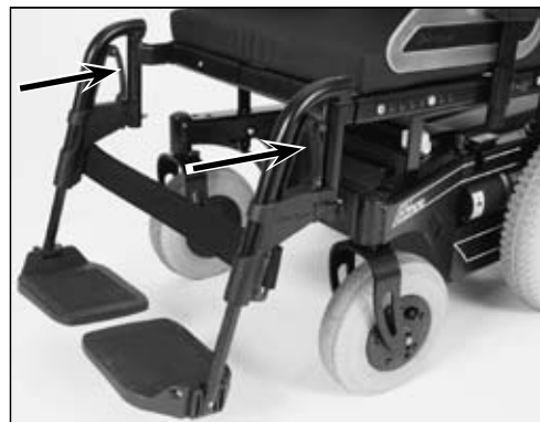
Fig. 10 Bloqueo de los reposapiés
