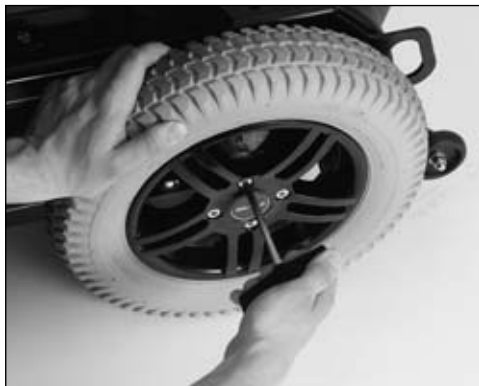
Fig. 29 Desmontaje de la rueda de accionamiento
