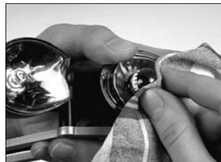
Fig. 22 Sustitución de las luces intermitentes
