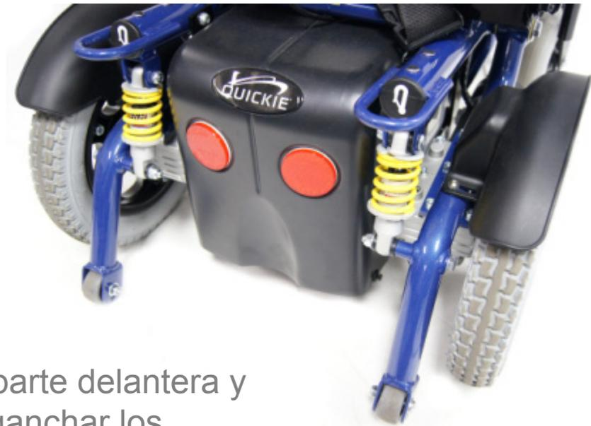
Con anclajes standard en la parte delantera y trasera del armazón para enganchar los sistemas de retención en vehículos
