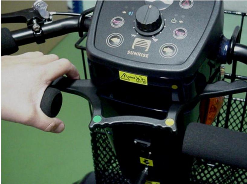
El diseño del mando de aceleración permite su manejo con toda la mano
