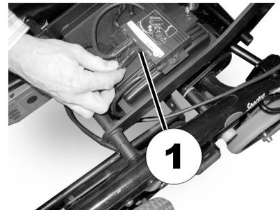
Guíe el cable del mando por debajo del soporte del asiento y conéctelo al sistema electrónico.
