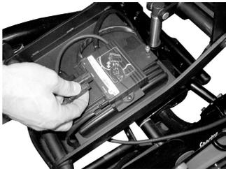
Tire de la clavija del cable del mando para desconectarlo del sistema electrónico.
