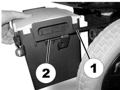
Cuando inserte las cajas de las baterías, asegúrese de que las varillas guía (1) queden justo dentro de los canales guía (2) del lateral de las cajas de las baterías y no por debajo de ellos.
