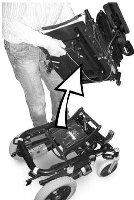
Extraiga el asiento hacia arriba. Según el tipo de asiento que sea, puede pesar entre 16 y 23 kg. Pida ayuda a otra persona si le resulta demasiado pesado para levantarlo solo.
