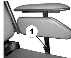
El reposabrazos del Asiento firme está equipado con un tornillo (1) que se utiliza como tope. La altura del reposabrazos se ajusta utilizando este tope.
