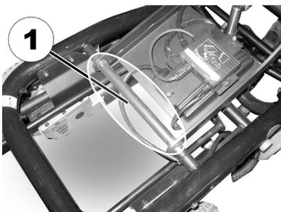
Asegúrese de que no haya ningún cable en la zona que rodea la barra estabilizadora trasera (1) para evitar que estos resulten dañados.
