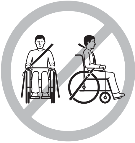
i Colocación incorrecta del cinturón de seguridad
