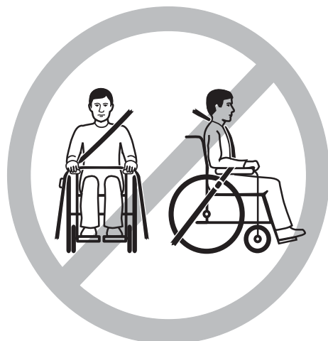
i Colocación incorrecta del cinturón de seguridad
