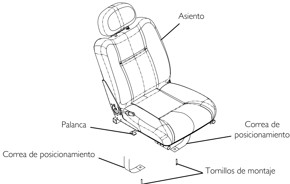
ILUSTRACIÓN 7.8 Sustitución de la correa de posicionamiento del asiento
