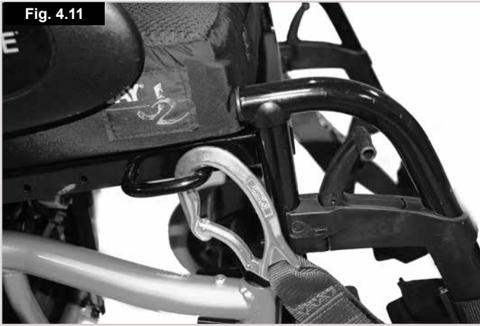
Ubicación de la correa de sujeción delantera (Fig. 4.11).
